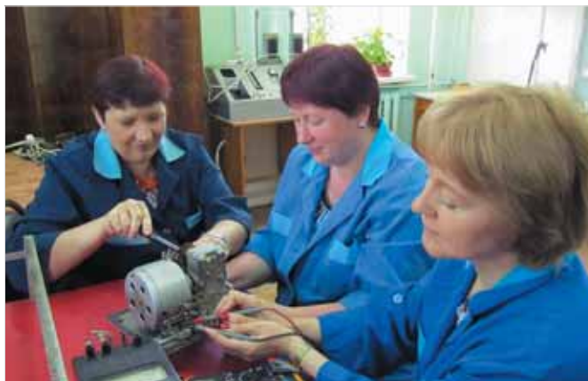
Электромеханики Л.А. Свистунова, Н.В. Ермошина, Е.Г. Полякова за проверкой трансмиттера КПТШ
