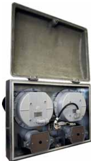
Новый светодиодный переездный светофор в едином полимерном корпусе
