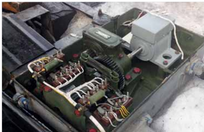
Стрелочный электропривод с бесконтактным управляемым электродвигателем
