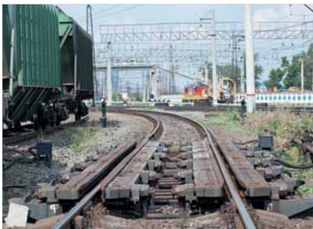
Модернизированный клещевидный вагонный замедлитель КЗПМ с пневмокамерами
