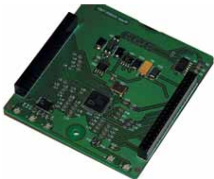
Унифицированный микропроцессорный модуль управления (для блоков РКП-ТС, РКП-ТУ, РКП-ОТУ)
