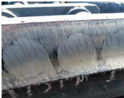
Композиционная тормозная шина вагонного замедлителя ШТ КСБ
