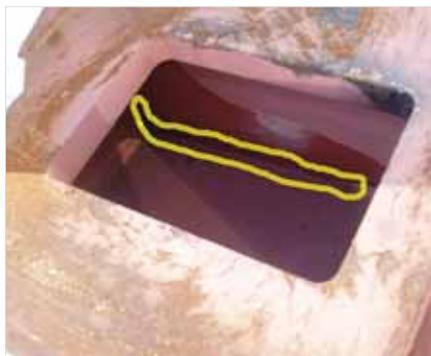
Пример приводной секции КЗ-3пк без сварочных швов в зоне площадки крепления прижимных болтов
