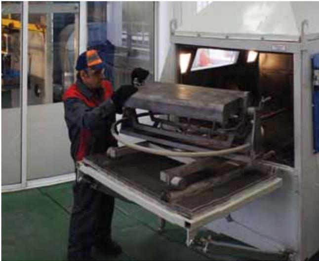
Электромонтер В.Д. Баранов выгружает крышку стрелочного электропривода из дробеструйной камеры
