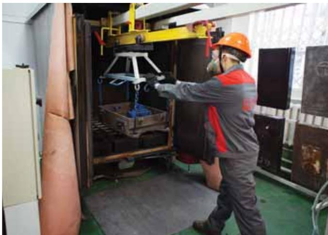
Электромонтер П.Н. Ошейко загружает корпус стрелочного электропривода в термочень
