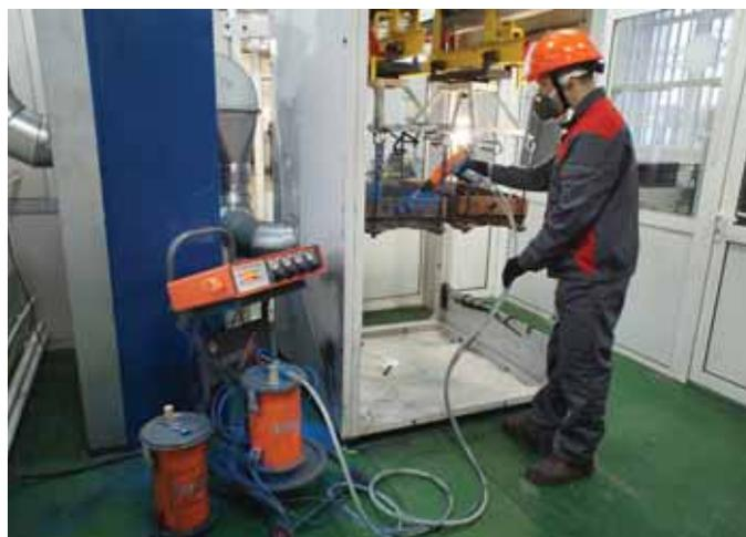
Электромеханик А.С. Пашченко окрашивает корпус стрелочного электропривода полимерными материалами
