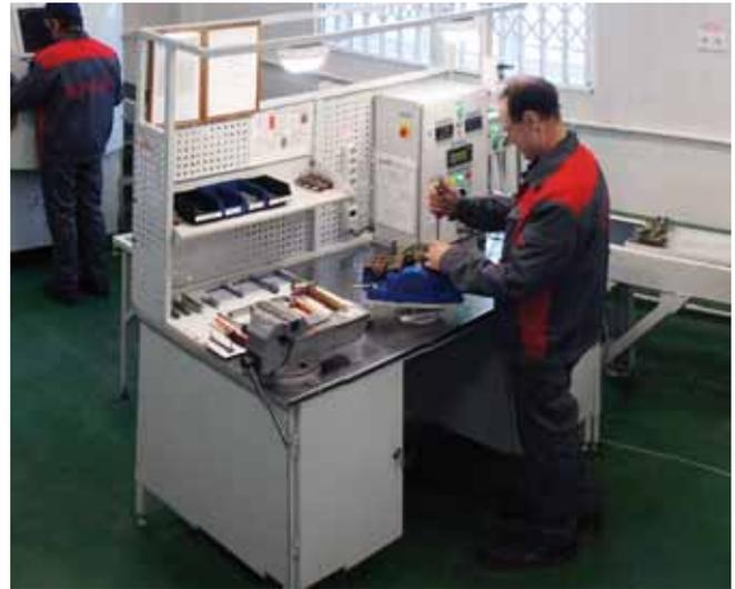
Электромонтер В.Б. Еремин разбирает блок главного вала и автопереключатель стрелочного электропривода
