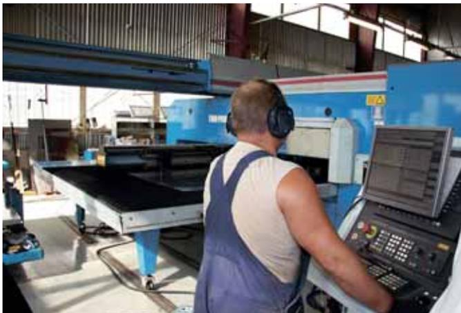
Станок с ЧПУ для штамповки изделий
