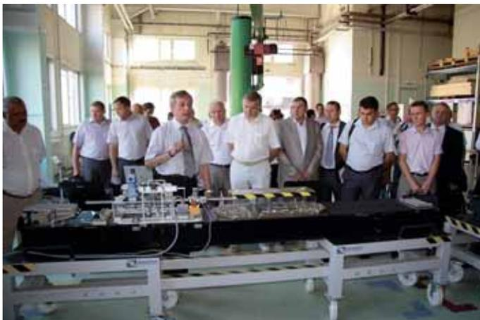
Стенд для испытаний шпального электропривода EBISwitch 2000
